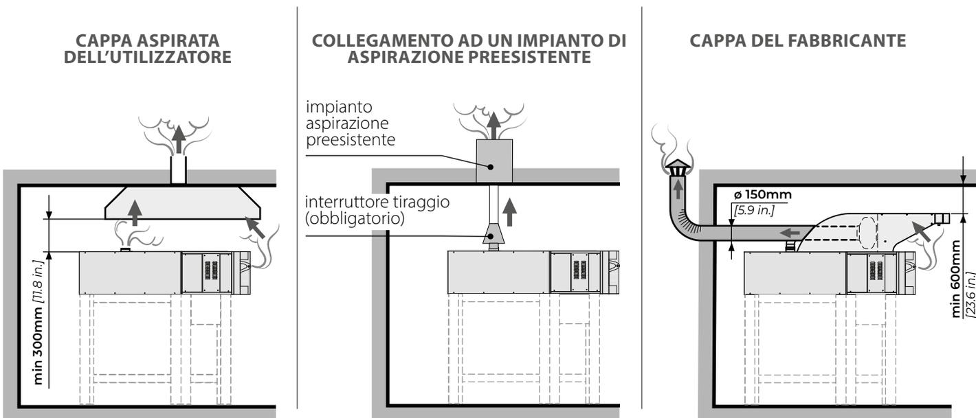
La canna fumaria di evacuazione deve essere ad uso esclusivo dell'apparecchiatura, rispettare le normative vigenti e avere un diametro che consenta il passaggio di un tubo di evacuazione di  $\varnothing 150$  mm [5.9 in.].
