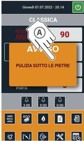
Ein interner Zähler im Ofen zählt die geleisteten Betriebsstunden. Nach einer bestimmten Stundenzahl erscheint ein Pop-up auf dem Display mit dem Hinweis auf eine notwendige Wartung des Ofens. Nach Durchführung des erforderlichen Vorgangs (z. B. Reinigung unter den Steinen) muss der Zähler wieder auf Null zurückgesetzt werden.
